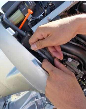
7. Befestigen Sie das Ablaufrohr wieder am Vorsprung des Einlassstutzens.
