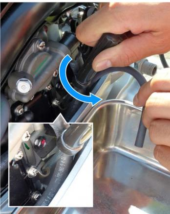
5. Fangen Sie das Benzin mit der Auffangwanne auf, sobald es aus dem Ablassrohr herausläuft.
