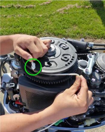
9. Setzen Sie das verknotete Ende der Notstartsnur in die Kerbe am Schwungrad.
