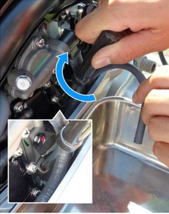
6. Ziehen Sie nach dem Entleeren die Ablassschraube fest an.
