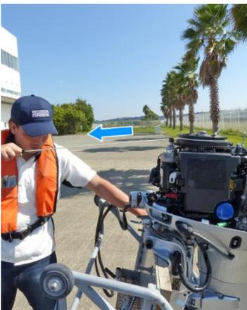
17. Ziehen Sie mehrmals an der Notstartschnur, um das Innere des Zylinders zu schmieren. Entfernen Sie anschließend die Notstartschnur.
