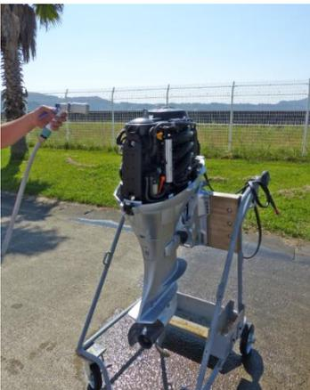
2. Spülen Sie den Außenbordmotor mit klarem Wasser ab, um Salzwasser, Sand, Schlamm usw. zu entfernen.
