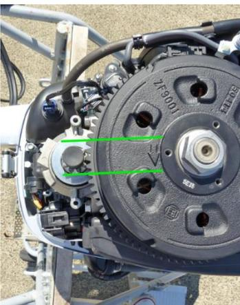
7. Drehen Sie den Rotor des Wechselstromgenerators gegen den Uhrzeigersinn, so dass der Pfeil wie abgebildet mit dem Anlasser ausgerichtet ist.
