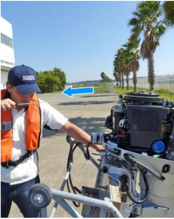
15. Entfernen Sie die ACG-Abdeckung. Wickeln Sie das Notstartschnur auf (siehe Notstartvorgang). Lassen Sie das Wasser durch mehrmaliges Ziehen der Startschnur aus dem Zylinder ab.
