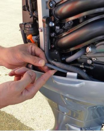
3. Lösen Sie das Ablaufrohr von dem Vorsprung des Einlassstutzens und führen Sie das Ende des Ablaufrohres unterhalb der Abdeckung heraus.
