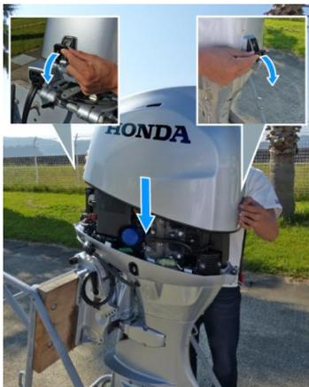
14. Lassen Sie die Abdeckung des Wechselstromgenerators weg, und setzen Sie die Motorabdeckung auf. Schließen Sie die Befestigungsschnallen der Motorabdeckung.
