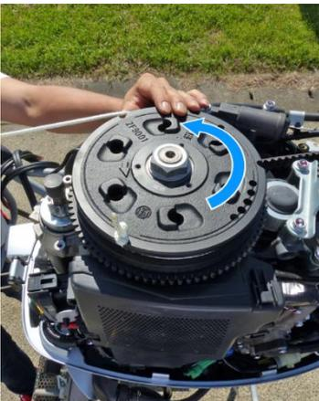
10. Wickeln Sie die Notstartsnur dreimal entlang der Nut im Rotor des Wechselstromgenerators im Uhrzeigersinn um das Schwungrad.
