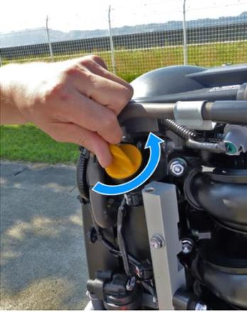
9. Nehmen Sie den Deckel der Öleinfüllöffnung ab.
