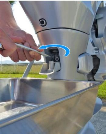
10. Stellen Sie einen geeigneten Behälter unter die Ölablassöffnung, entfernen Sie die Abdeckung der Motorölablassschraube und die Dichtungsscheibe. Lassen Sie das Altöl solange laufen, bis es nur noch herausröpfelt.
