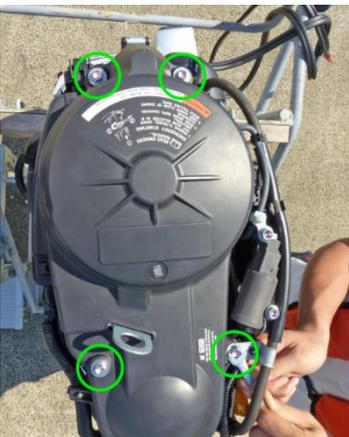
3. Entfernen Sie die vier Schrauben und die ACG-Abdeckung.
