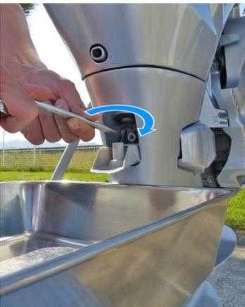
11. Montieren Sie nach dem Ablassen des Öls die Ablassschraube und die neue Dichtungsscheibe und ziehen Sie die Schraube fest an. Setzen Sie die Ablassschraubenabdeckung auf.
